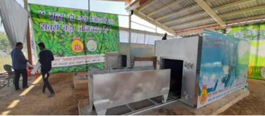
चित्र 2: उन्नत लकड़ी आधारित दाह संस्कार सभी अनुष्ठानों को करने के प्रावधान और नियंत्रित उत्सर्जन के साथ जो प्रति दाह संस्कार में दो पेड़ों की लकड़ी बचाने के बराबर बचत कर सकता है।
