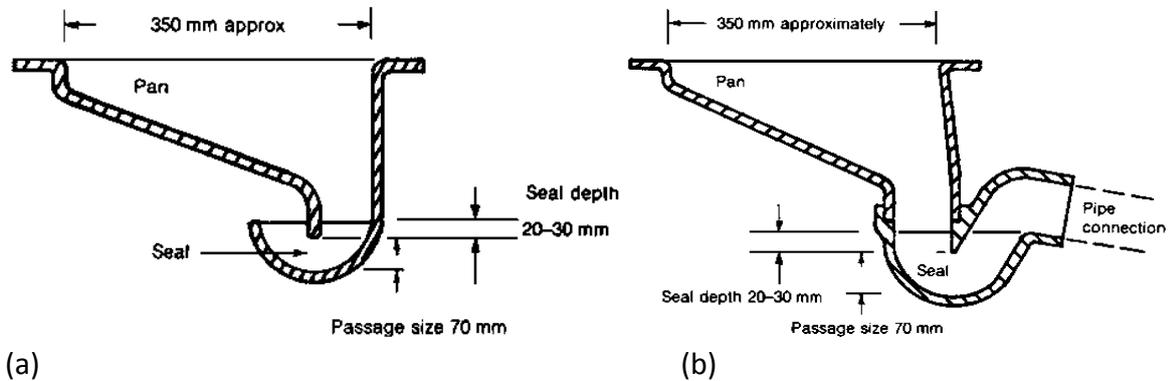
**Figure 3.9** Design of a pour flush toilet. (a) Direct Pour Flush; (b) Offset Pour Flush
